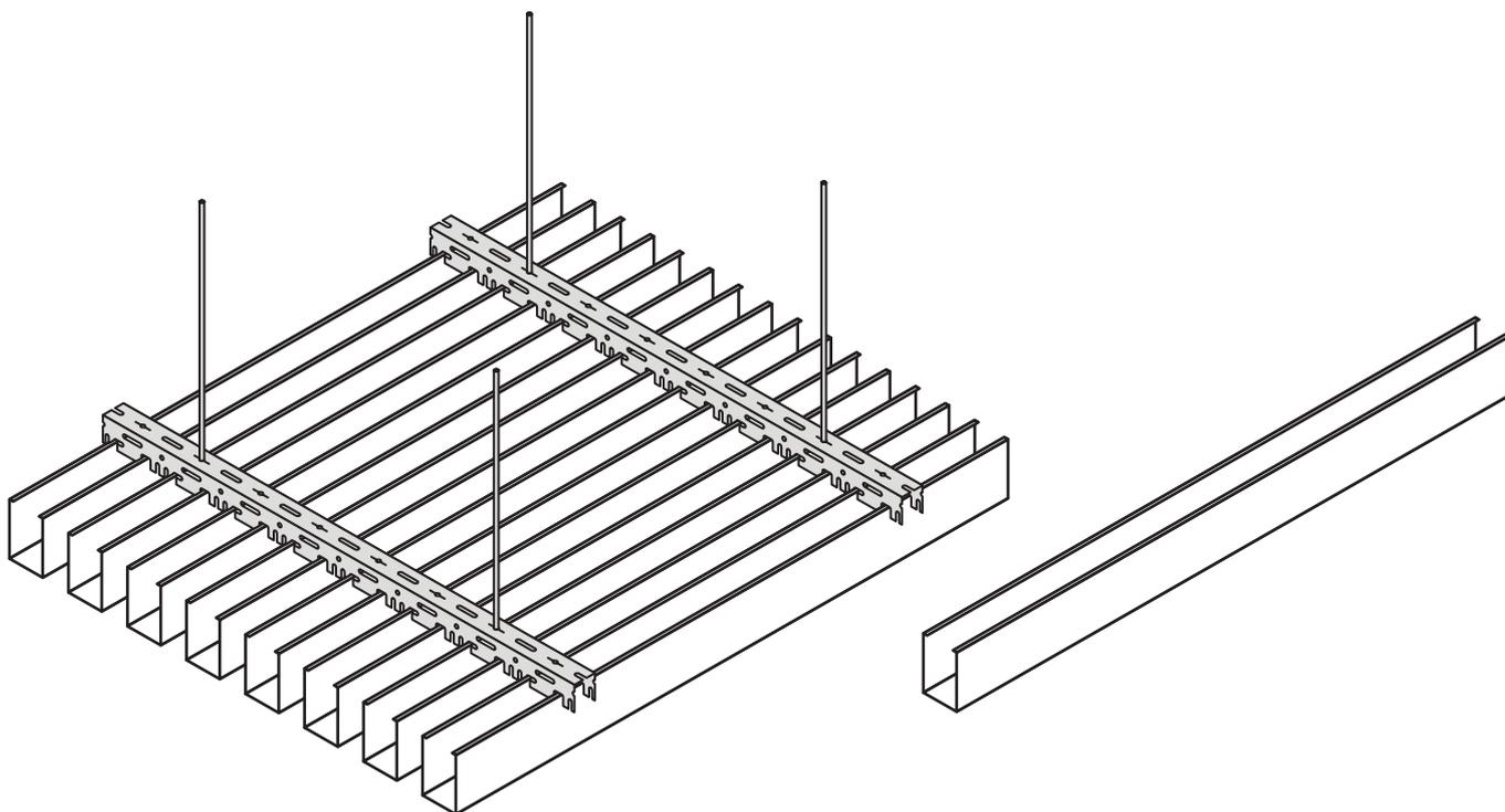
Кубические потолки, известные также как кубообразные реечные потолки, представляют собой подвесную конструкцию из П-образных профилей квадратного или прямоугольного сечения, изготовленных из высококачественной оцинкованной стали с полимерным покрытием.
