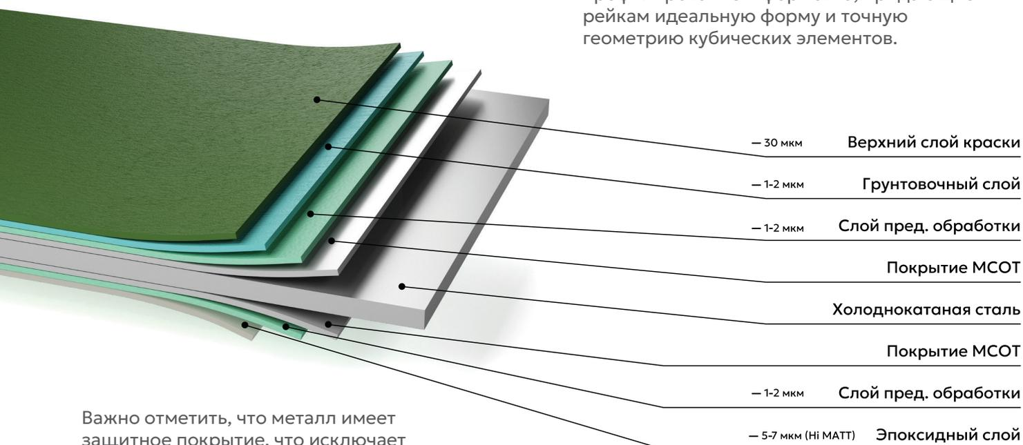
Важно отметить, что металл имеет защитное покрытие, что исключает необходимость дополнительной обработки и ускоряет производственный процесс.
