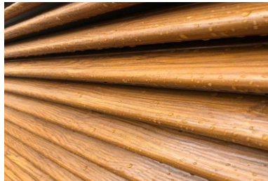
Ламель симметрика устанавливается на заклепки ф4,8мм или при помощи лепестков с шагом 60мм. Мин. длина 0,45м, рекомендуемая макс. длина до 3м
