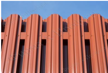
Штакетник устанавливается с зазором от 5 мм на заклепки или саморезы. Минимальная длина штакетника 300мм
